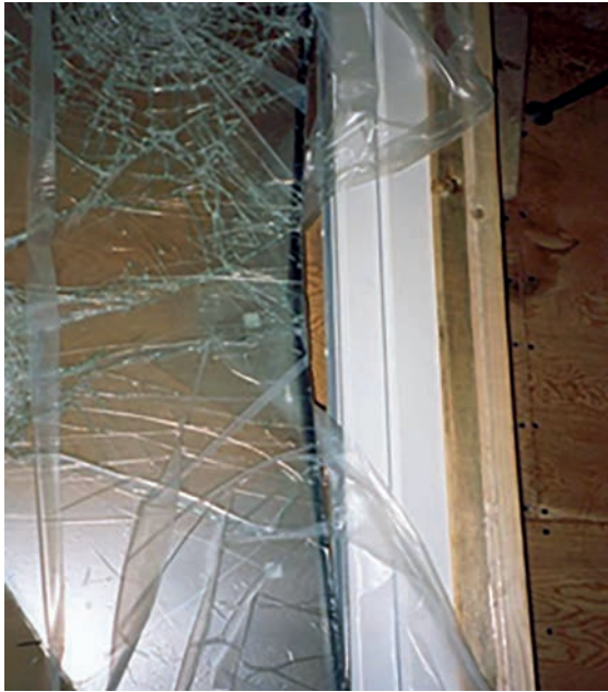
Bild 12 Prüfung von hurrikantauglichen Bauelementen im ift Rosenheim gemäß [16]
